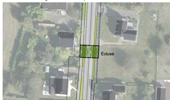
Zoom - Écluse plantée phase opérationnelle
